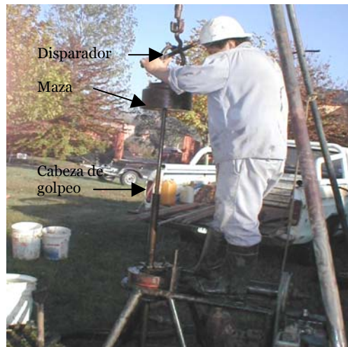
Dispositivo para ejecutar el SPT
